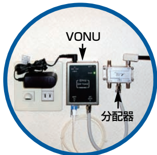
※ VONU : 光信号を電気に変える装置
